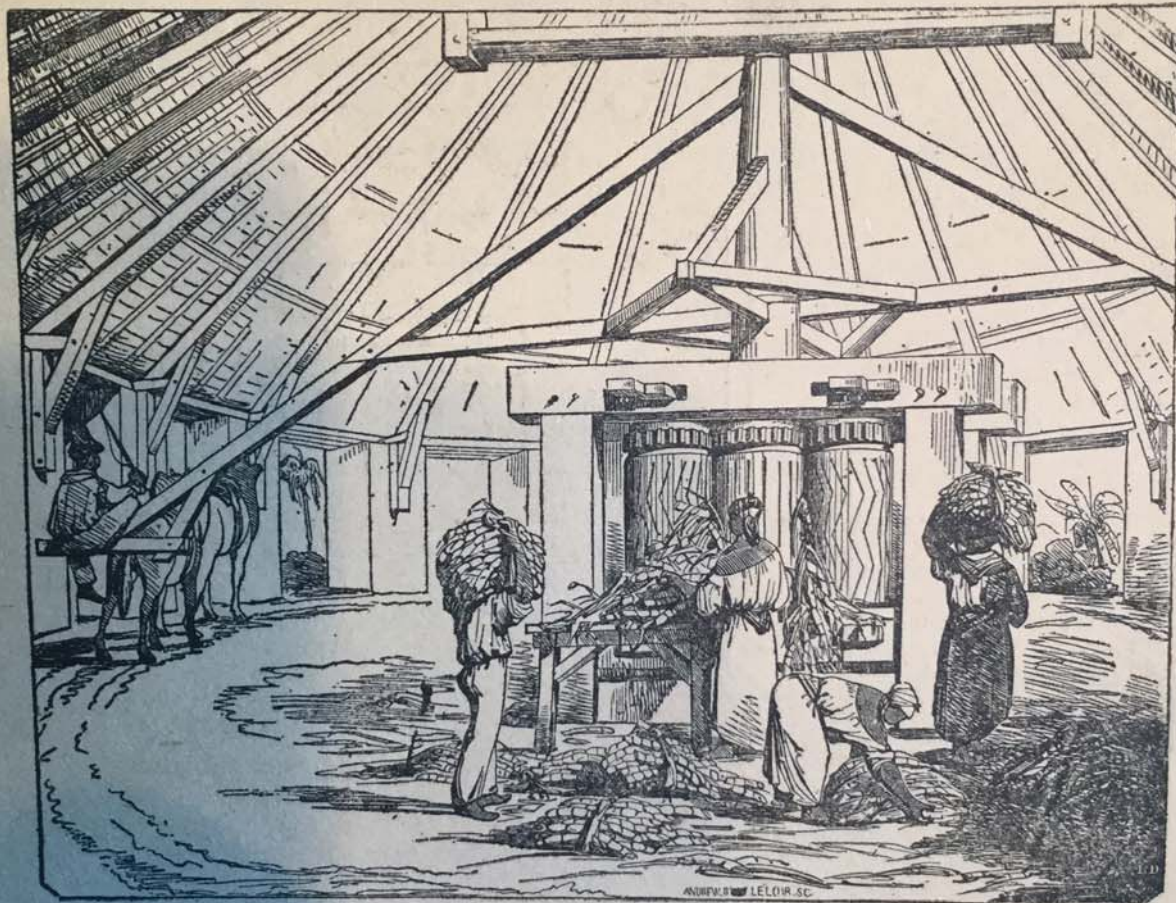
FIG. 4. — Moulin vertical à manège en l'air (Martinique, XIX e siècle).
