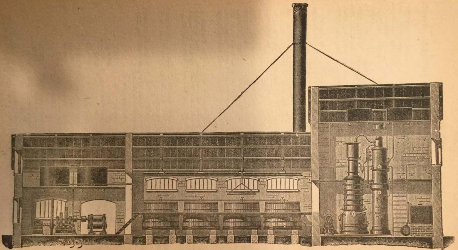
FIG. 19. — Distillerie de canne installée par Egrot et Grangé. — Coupe longitudinale.
